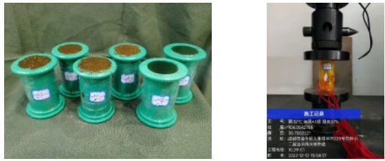
(a) 浇筑试件 (b) 单轴抗压加载 图7 单轴抗压试验图
